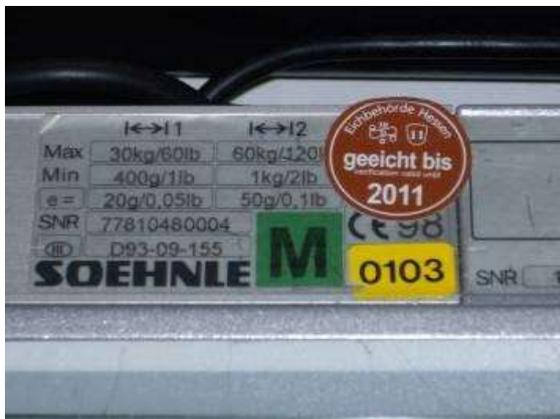
Abb. 6: geeichte Waage
